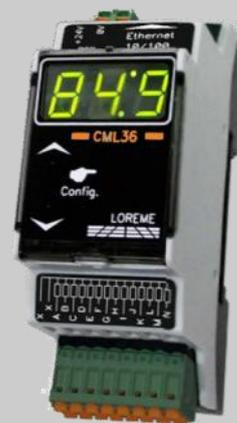
**Le CML36 est une centrale de mesure de température compacte permettant de concentrer jusqu'à 32 modules de 14 voies sur une seule liaison Ethernet (protocole Modbus TCP) par l'intermédiaire du Bus interne.**
